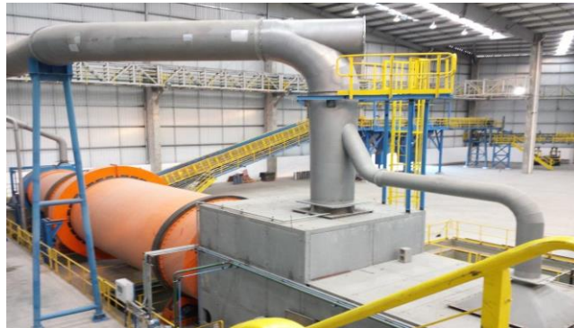
Figura 10. Exemplos de enclausuramentos e captores
