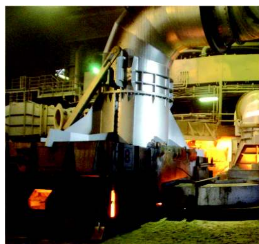
ThyssenKrupp Steel, Duisburg/ Alemanha AF 1 Schwelgern Captação na calha basculante com 290.000 m 3 /h
