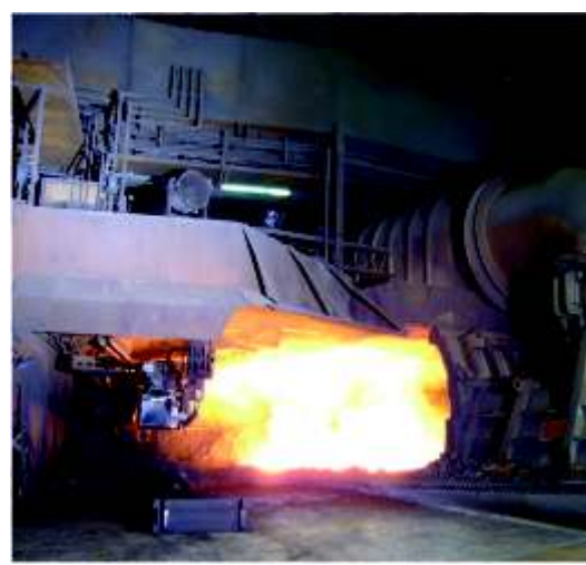
ThyssenKrupp Steel, Duisburg/ Alemanha AF 1 Schwelgern Captação de gás no furo da corrida com 125.000 m 3 /h, assim como no canal de corrida com 500.000 m 3 /h
